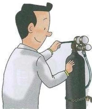
启或关闭瓶阀时，只能用专用扳手缓慢进行，防止因高速产生静电。绝对不能使用锤子、管钳等工具进行开闭，以免阀件或压力表受冲击而失灵。用完后先关闭总阀门，待减压阀中余气逸尽后再关闭减压阀。
