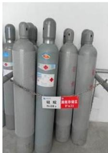
(3) 气瓶应立放在专用场所并进行固定，以免碰倒。搬运时要旋上钢瓶帽，使用专用手推车，以免钢瓶滑脱。搬运中应轻装轻卸，防止震动，氧气瓶应装有防震胶圈，不能用电磁起重机吊运气瓶。
