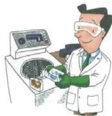
使用隔热手套取物品
